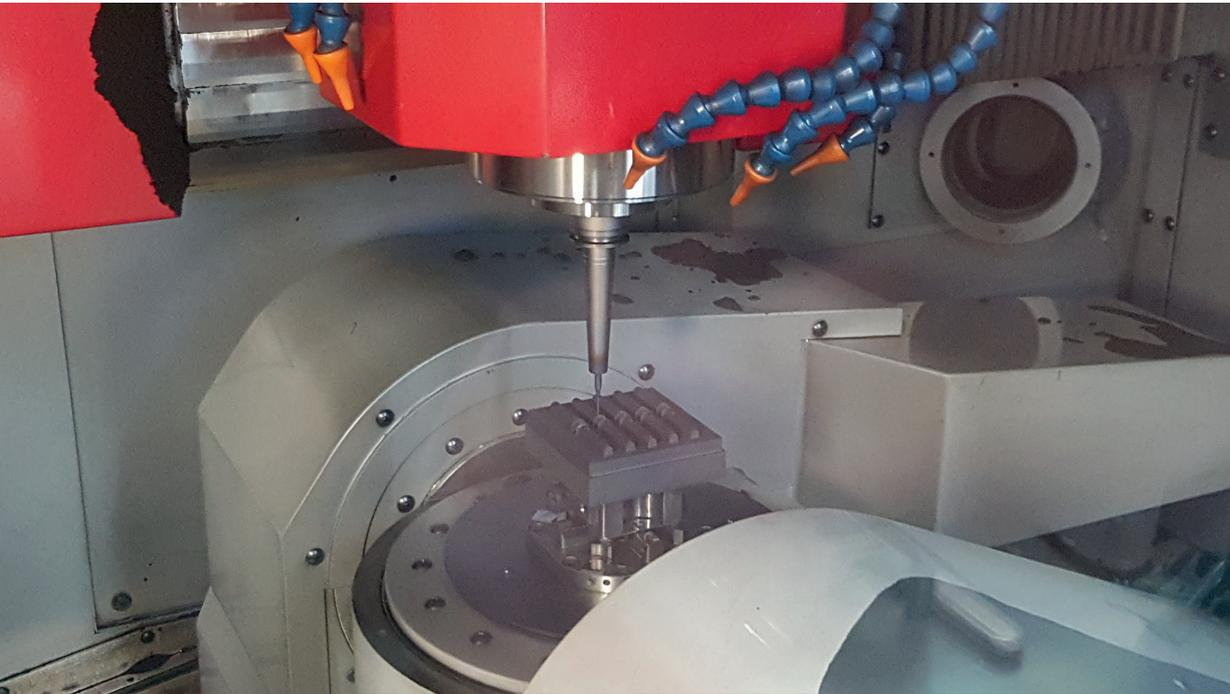
**Progression im Arbeitsraum:** Mit Torus- und Kugelfräsern von Moldino hat Fischer Werkzeugbau beim Elektrodenschlichten den Vorschub um den Faktor drei erhöht und ist trotzdem noch maßgenauer als zuvor © Moldino
