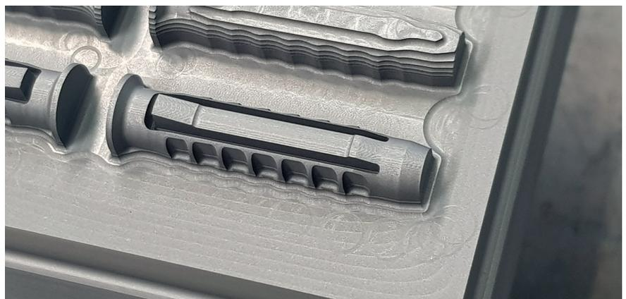
**Feines Ergebnis:** Beispielektrode für die Dübelfertigung nach dem Schruppen und nach dem Schlichten zweier linker Dübelhälften auf Endmaß mit einem Moldino-Kugelfräser D-EPDB-2004-4 © Moldino
